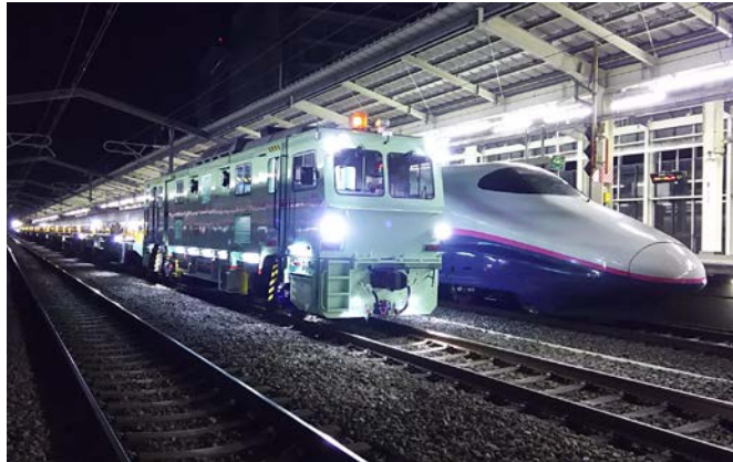
REXS(新幹線レール交換システム)
